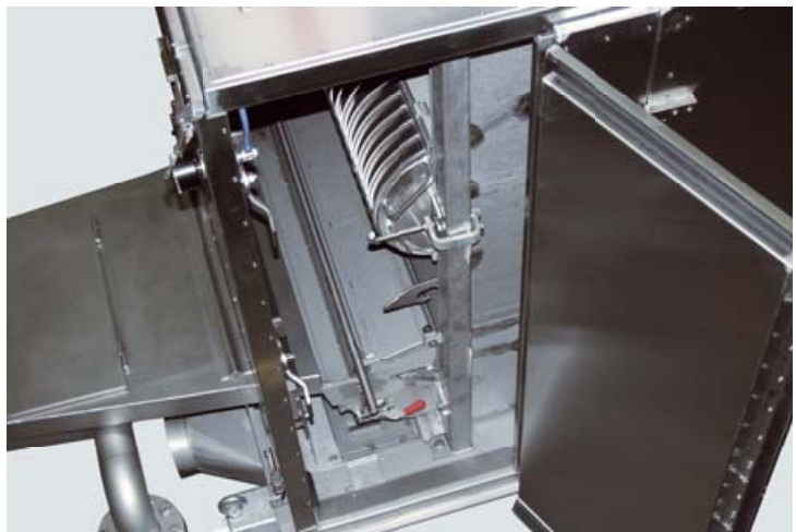
Vorentwässerung und Bogensieb im Pralltrockner AERO
