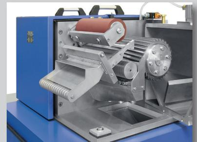
Das einfache Hochschwenken der oberen Einzugswalze und des Strangeinzuges erleichtern und beschleunigen die Reinigung enorm.
